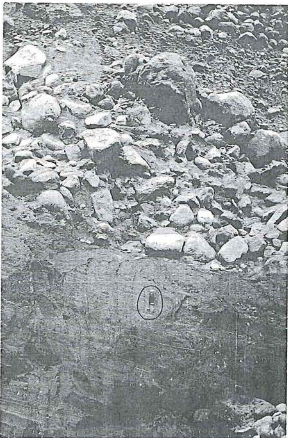
Fig. 52. Snitt i 60-meters terrassen ved Materstad, sett mot SSV. Øverst 1-2m sekundært omleiret materiale i nær horisontale lag. Under dette foresetlag med stor materialveksling.
