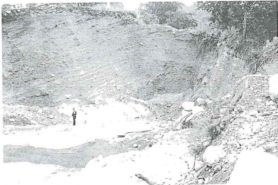
Fig. 62. Snitt i viften ved Eik, ca. 14 m o.h. Lagene faller mot nord og består for det vesentligste av grusholdig sand.
