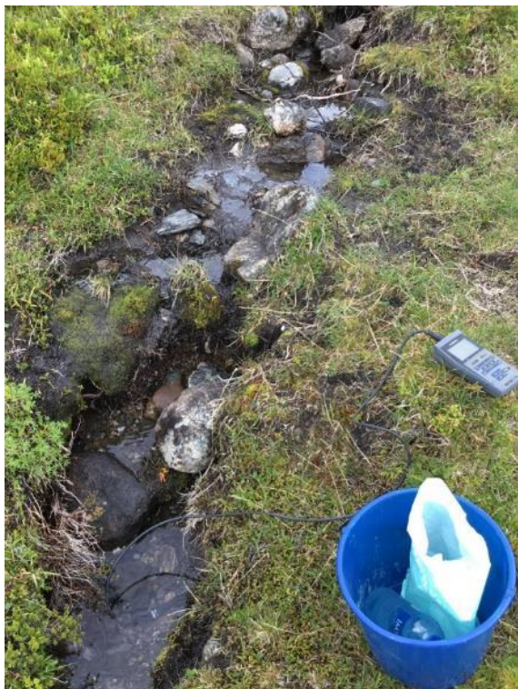
Figur 6.9 Bilder viser en konduktivitetmåler som måler elektrisk konduktivitet og temperatur i vann.
