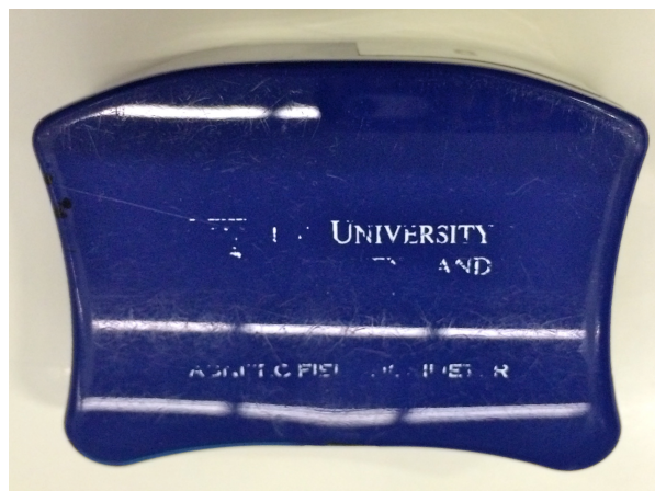
Figur 5: Personlig dosimeter til måling av elektro magnetiske felt, utviklet av Professor Stuart Crozier, Universitetet i Queensland, Australia
