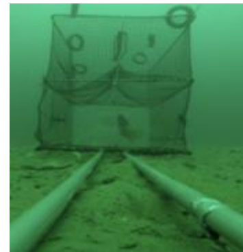
Figur 12. Bilde av tilsvarende tokammerteine brukt i forsøkene. Det er transparent filament brukt i åpningene. Bilde: Anders (2015)
