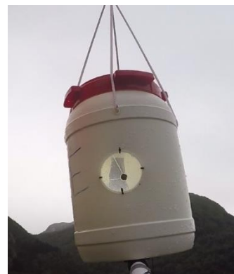
Figur 8. 1 av 6 lysfeller. En kan se lykta henge fra lokket gjennom den gjennomsiktige trakta.
