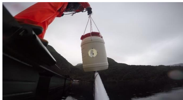
Figur 14. Viser lysfellen med kameraet festet i plastrøret på undersiden, 1m fra lysfellen.
