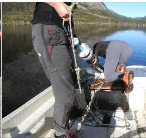
Fig. 4.4 (venstre): Desinfisering av 'UWITEC gravity-coreren' for å unngå overføring av mulige fremmede skadeorganismer til Uskedalsvassdraget. Foto: Ole Martin Nuven.
