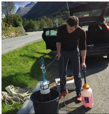
Fig. 4.4 (venstre): Desinfisering av 'UWITEC gravity-coreren' for å unngå overføring av mulige fremmede skadeorganismer til Uskedalsvassdraget. Foto: Ole Martin Nuven.
