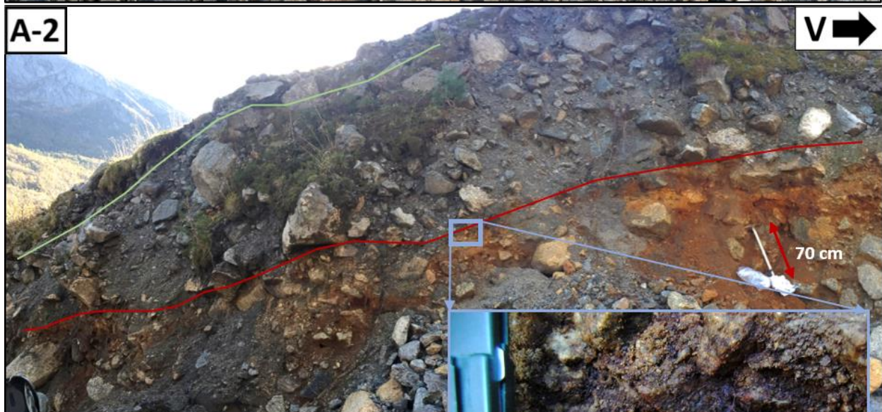
Fig. 5.16; 5.17: På begge sidene av erosjonssporet på lokalitet A-2 kan snittene skilles i to inversgraderte lagpakker med ulik farge. Rød strek antyder farge-skiellet, og grønn strek markerer det moderne jordprofil. Isøks som målestokk (70 cm).
