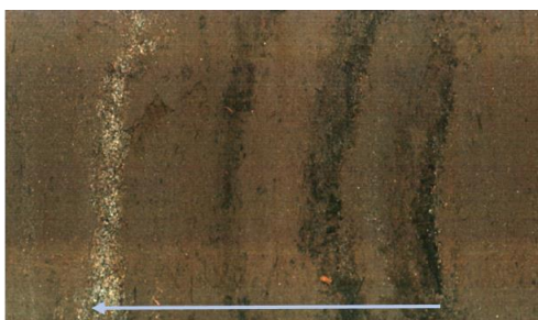
Figur 4.7: Dette er et utsnitt fra VATP216 hvor både enhet A (lyst lag), enhet B (brune lag) og enhet C (svarte lag) er representert. Pilen viser rett vei opp og representerer 10 cm.
