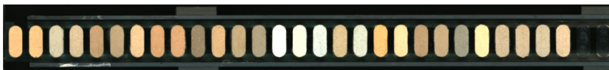
Figur 3.1: Bilde tatt av XRF- skanneren som viser de 28 nedslagsfeltprøvene i PVC-skinne.
