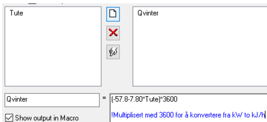
Figur C.2: Skjermdump som viser hvordan den lineære funksjonen for belastningen i varmesesongen er definert i komponenten som modellerer denne.
