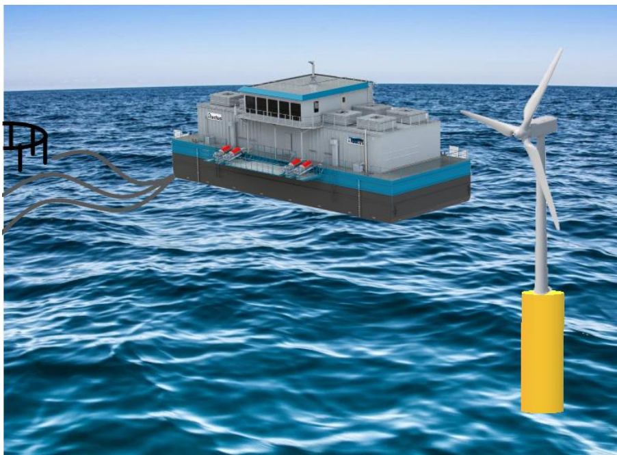
Figur 32 Skisse over flytande vindturbinar ved oppdrettsanlegg.
