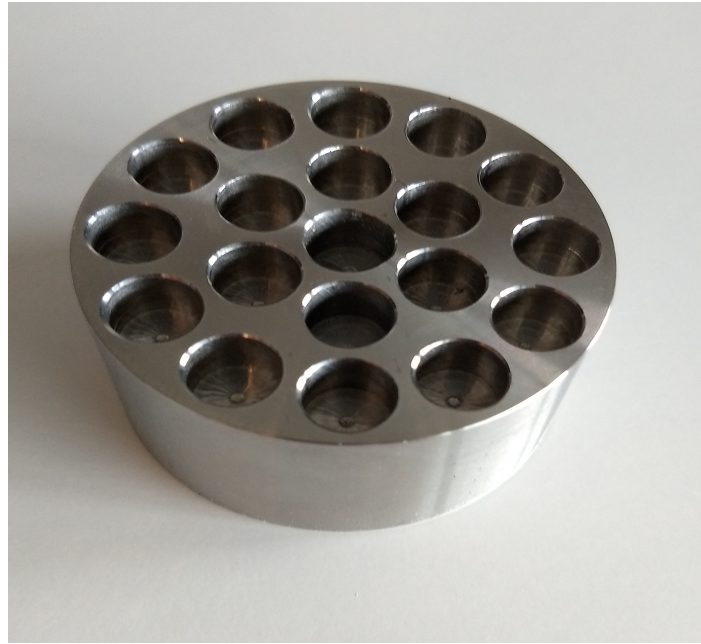
FIGUR 3.6: Sluttproduktet av reflektoren med nitten sirkulære nedsenkninger.
