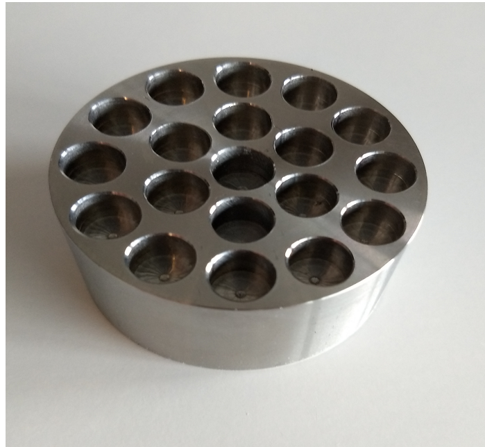
FIGUR 3.13: Den maskinerte utgaven av reflektor 3 med nitten sirkulære nedsenkninger.
