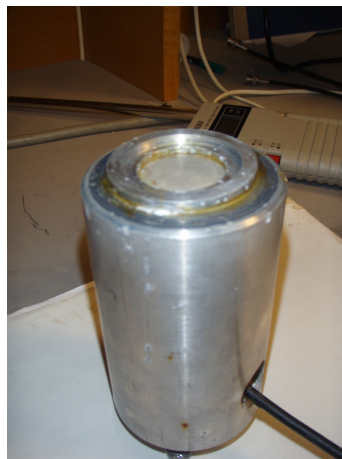
Figur 3.4: Transduseren med både baklag og frontlag. Selve elementet er montert i et metallchassis.
