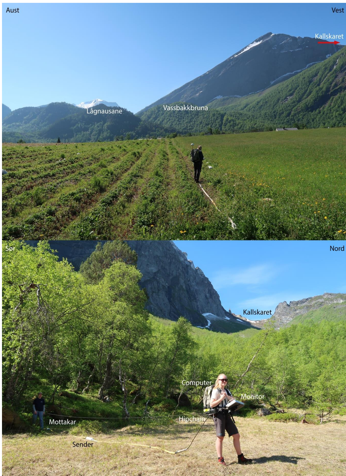
Figur 4.3: Øvste bilete viser innsamling av profil P1 over ein jordbæråker nær fjorden. Avsettinga til Kallskarskredet ruvar i bakgrunn. Nedste bilete viser innsamling av profil på Høystakkmyra med Malå «Rough Terrain Antenna». Begge foto: Henriette Linge.
