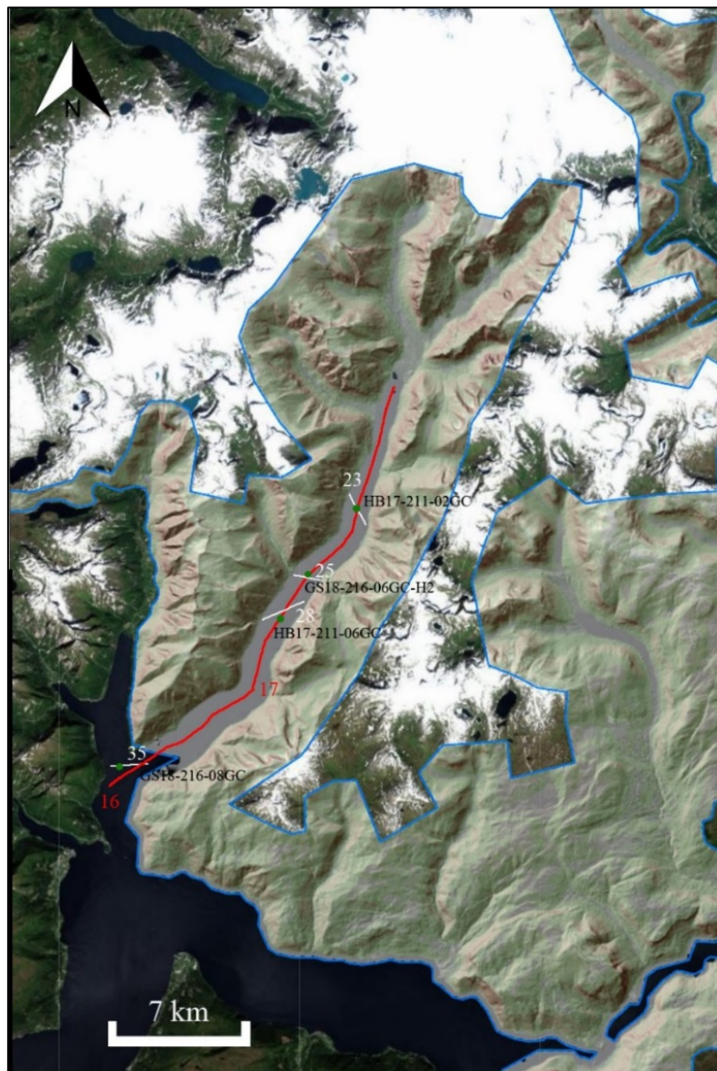
Figur 5.6: Lengdeprofil 16 og 17 (rød strek) og tverrprofil 23,25,28 og 35 (hvit strek) har blitt tolket i dette studiet. Lokalitet til kjerne 02GC, 05GC, 06GC og 08GC er plassert på kartet med grønn prikk.
