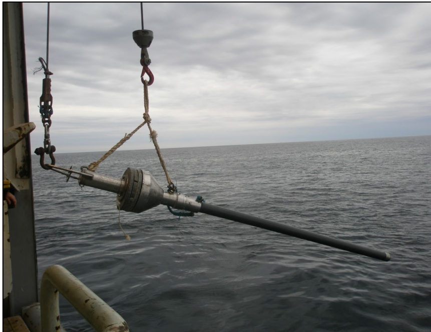
Figur 4.1: Fallprøvetaker som klargjøres for nedsenkning ombord i G.O. Sars. Foto: H.Haflidason.
