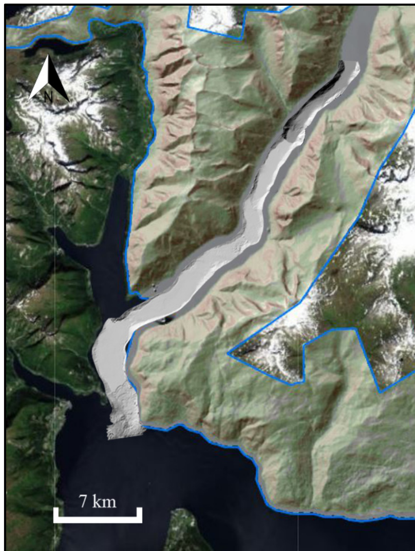
Figur 5.1: Skyggelagt topografikart over midtre og ytre del av Fjærlandsfjorden med batymetridata. Lysegrå batymetridata er med 5 m oppløsning og mørke grå batymetridata er med 10 m oppløsning.
