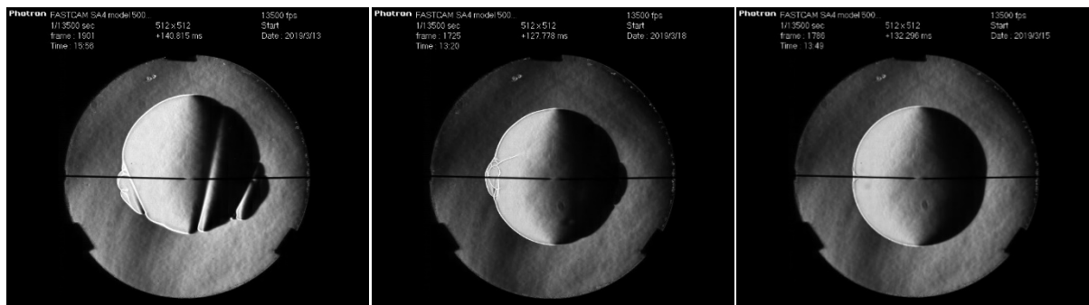
Figur 5.14: Schlieren-bilde av ekspanderende flamme ved 50 % tilsatt nitrogen. Bildet til venstre viser mager blanding, midten støkiometrisk blanding og høyre rik blanding.
