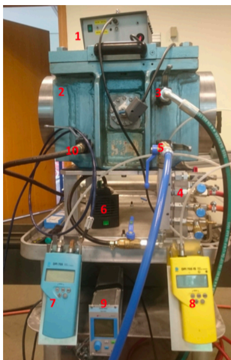
Figur 3.1: Hovedkomponenter til eksplosjonskammer: (1) gnistgenerator, (2) eksplosjonskammer, (3) eksoslinje, (4) gassmiksing- og fyllesystem, (5) luftinntak for rensing/spyling av kammer, (6) vakuumpumpe, (7) Trykkmåler for høytrykkreservoar (8) Trykkmåler for vakuum, (9) ladningsforsterker, (10) slange fra luftreservoar (Halland, 2015, s. 73).
