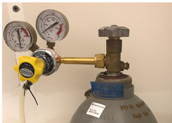
Figur 6.1: CO 2 -tanken som ble brukt i forsøkene
