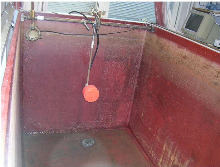
Figur 4: Venstre:200 kHz komposittsvingaren montert i tanken. Då dette bilete vart teke, var tanken tømt for vatn. Høgre: Nærbilete som illustrerer storleik.
