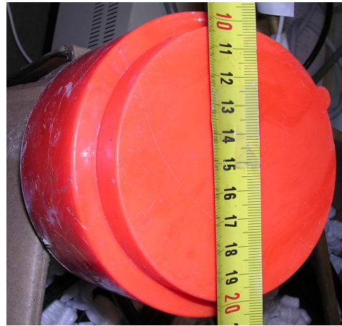
Figur 4: Venstre:200 kHz komposittsvingaren montert i tanken. Då dette bilete vart teke, var tanken tømt for vatn. Høgre: Nærbilete som illustrerer storleik.
