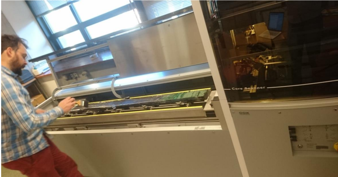
Figur 4. 7: NØKU118 prepareres og påføres en tynn plastfilm før XRF-skanning i en ITRAX Core skanner ved sedimentlaboratoriet på Universitetet i Bergen.
