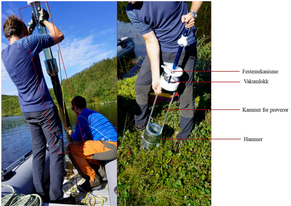
Figur 4. 2: Sedimentkjerne hentes opp fra Nøktjønna med 'UWITEC Gravity Corer'. Hovedkomponenter er navngitt.
