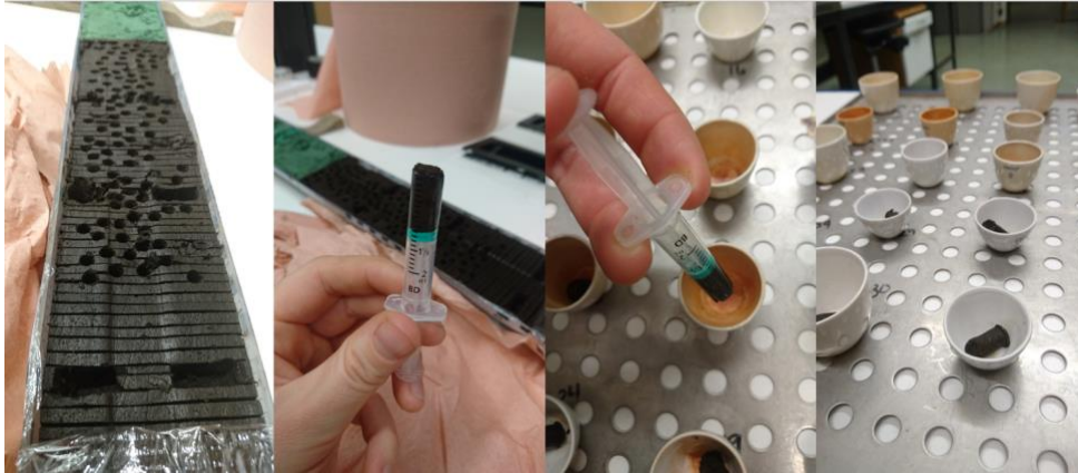
Figur 4. 8: Glødetapsprosedyre. Prøver på 1ml blir tatt ut for hver 0,5cm kjernedyp, fylt i digler og veid opp før tørking.
