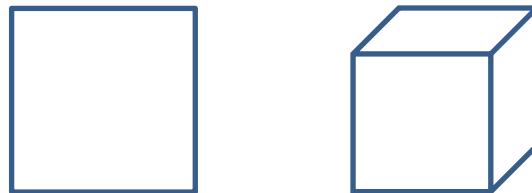
Figur 4: Figuren viser forskjellen på en pixel, som er et to dimensjonalt bilde-element, og en voxel, som er et tredimensjonalt bildeelement.
