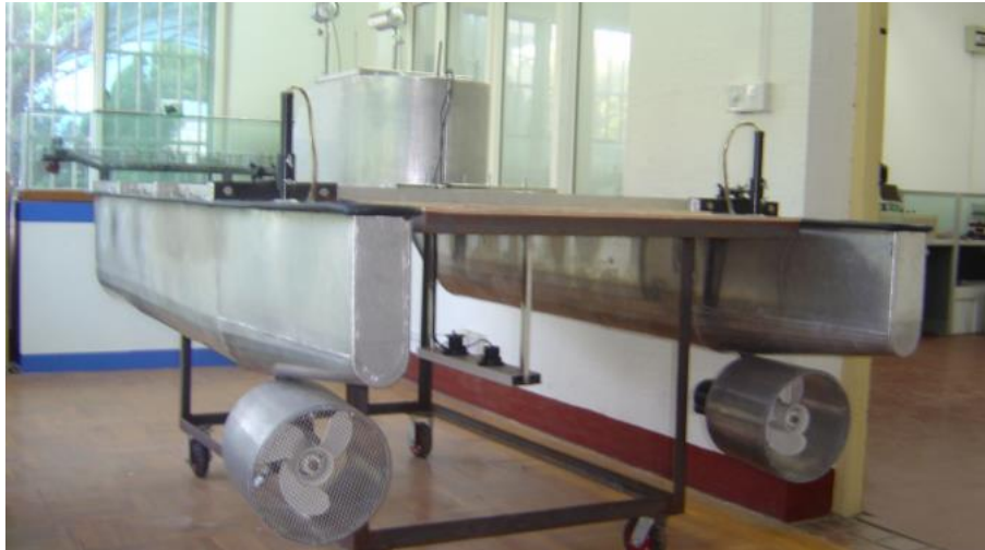
Figur 5: Design av katamaranformet asv [8]
