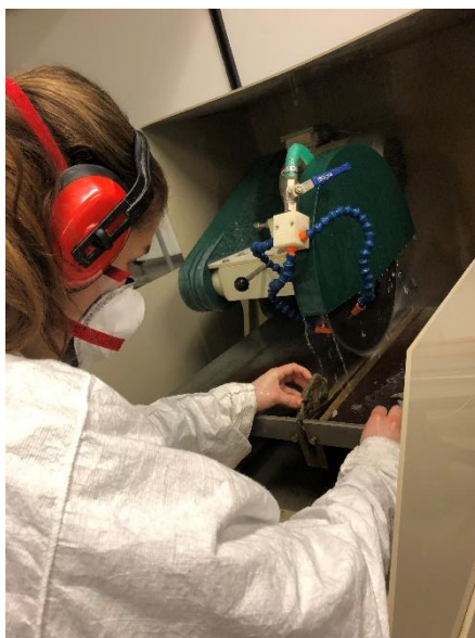
Figur 4.6.1: Preparering av bergartsprøve for laboratorieanalyser ved bruk av steinsag (BROT Technologies Saw).
