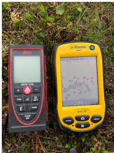
Figur 4.2.1: Kartleggingsutstyr i felt. Til venstre: Leica Disto TM X310. Til høyre: Trimble Juno 3B.
