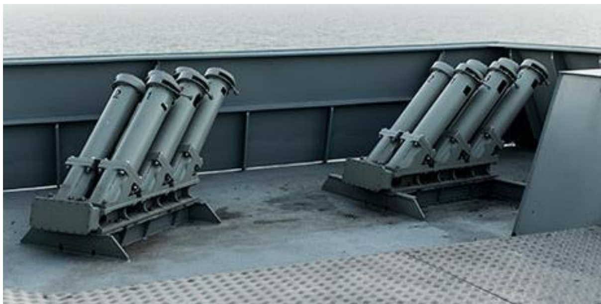
Bilde 4: Terma sitt 6-løps utskytningsrør (“6 tube launcher”) (Royal Danish Navy)
