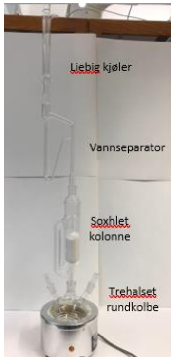
Figur 3.1: Oppsett av Soxhlet apparatur med vannseparator
