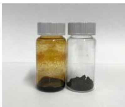
Figur 5.7: Olje og koks fra HTL-omdanning av biorest.
