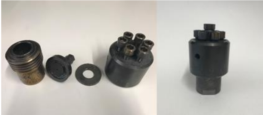
Figur 3.2: Bildet til venstre viser ulike deler av en reaktor; en dyp beholder, en overdel med ventileringshull, en metallskive og et topplokk med seks skruer. Bildet til høyre viser en lukket reaktor.
