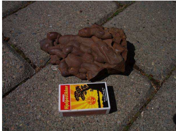
Figur 3.5 Renneslagg frå fase II (foto: K. Loftsgarden)
