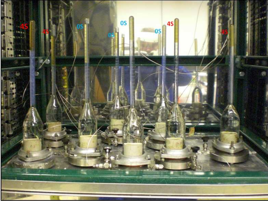
Figur 2.6: Imbibisjonsoppsett for 130 °C spontanimbibisjon. Kjerner med og uten tilsatt sulfat er markert i figuren.
