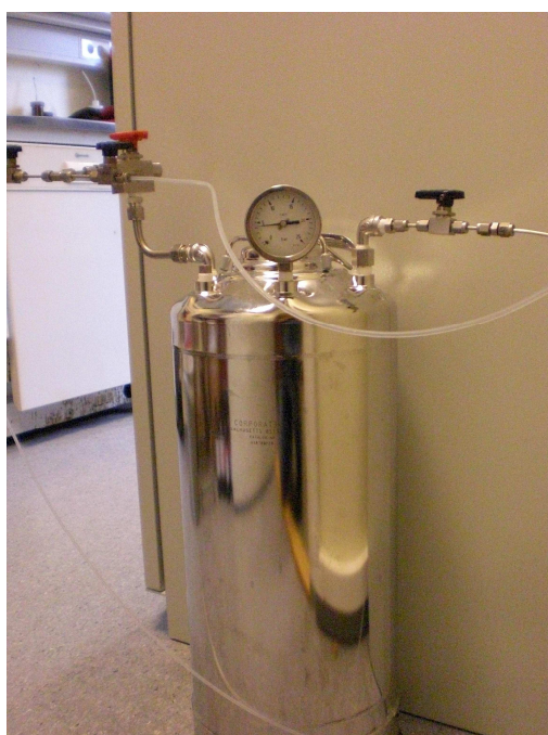
Figur 2.4: Trykktank som fører trykkstøtte inn til imbibisjonscellene. Tanken inneholder destillert vann.
