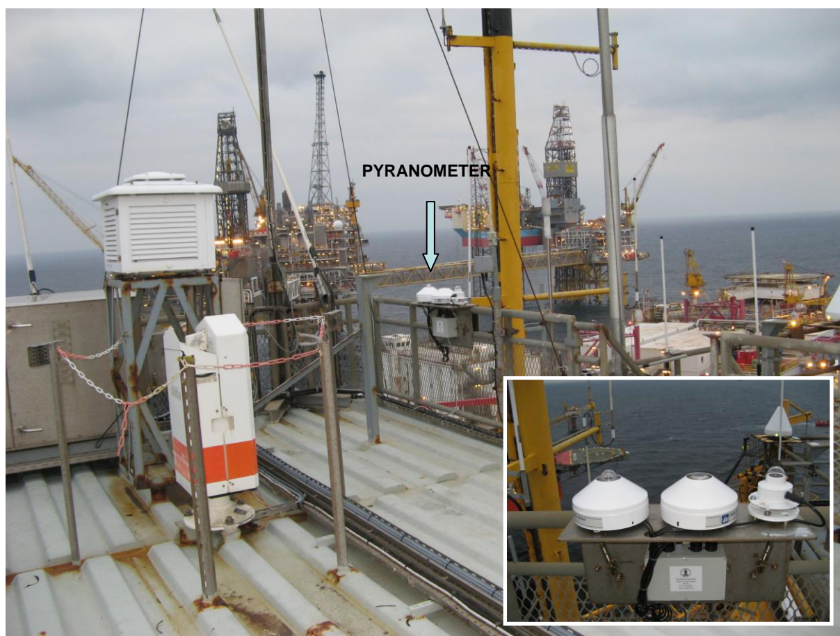
Figur 3.4: Plasseringen av 3 strålingsinstrumenter på Ekofisk. Kipp & Zonen CM11 pyranometeret (til venstre), Kipp & Zonen pyrgeometer (midten) og Solar Light UV-biometer (høyre) ses nederst til høyre i bildet. En hvit instrumenthytte kan ses til venstre i bildet. Foto: Jon Halvard Berntsen, met.no.
