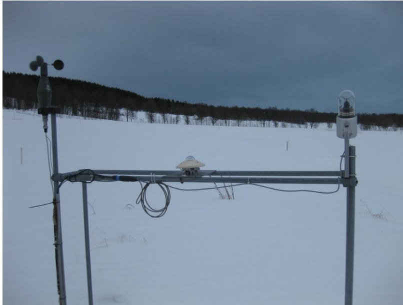
Figur 5.38: Plasseringen av pyranometeret på Holt. Til venstre ses et anemometer (Fabrikat Friedrichs) og til høyre en solskinnstidsmåler (Fabrikat Haenni modell Solar 11). Foto: Amelie Henden
