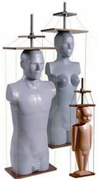
Figur 3.1: Bildet viser modell 701(voksen mann), 702 (voksen kvinne) og 704 (1 år barn)
