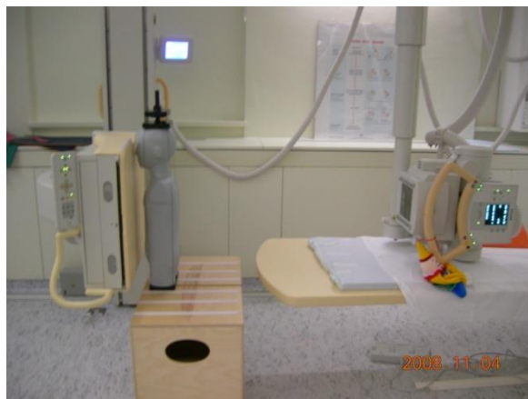
Figur 3.2 Innstilling av apparatur og fantom på Lab 1 ved Radiologisk avdeling Haukeland Universitetssykehus, seksjon for barn.
