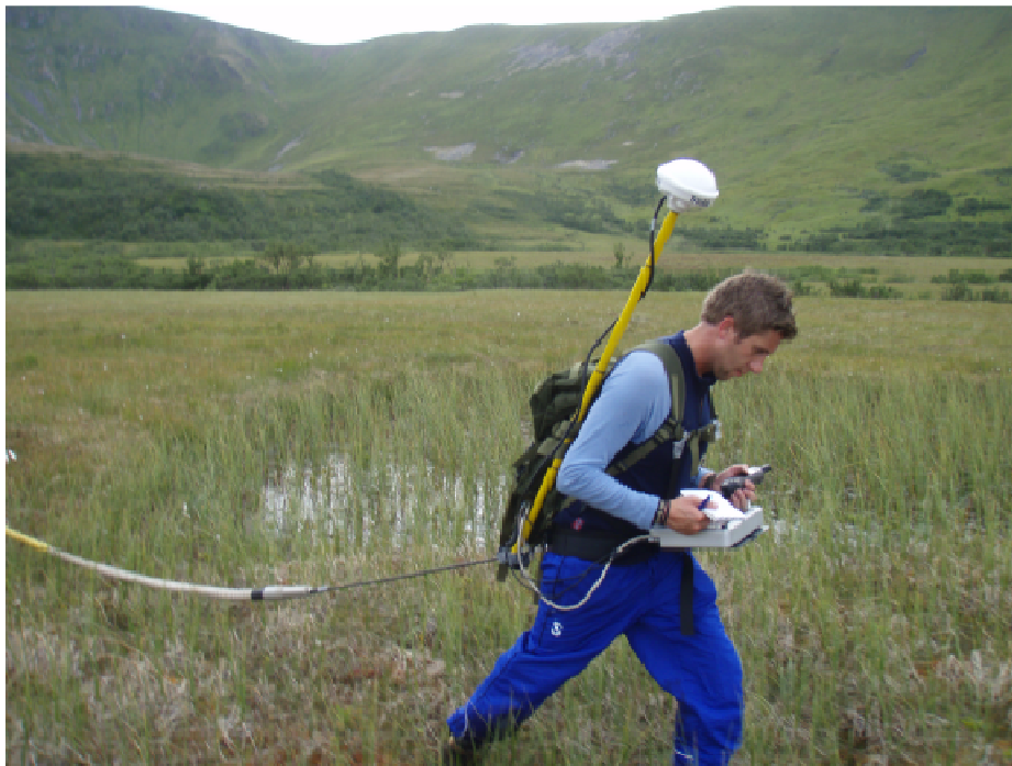
Bilete 1: Bruken av GPR-systemet i feltarbeid. Innerste del av Æråsdalen kan sjåast i bakgrunnen. Foto: Bjørn Kvisvik.
