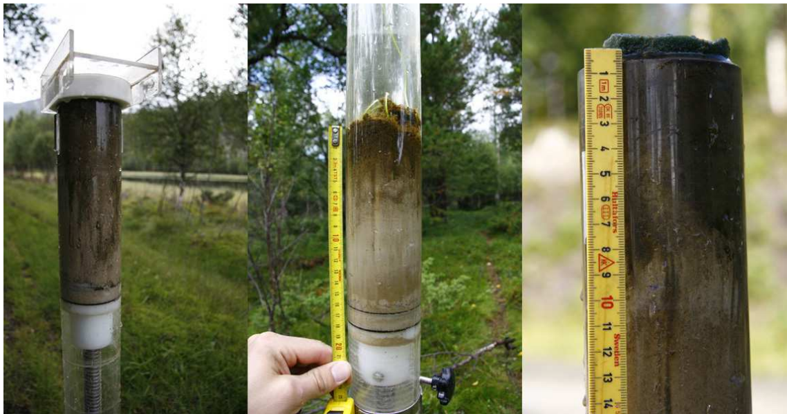
Bilde 2 -- Innsjøsediment tekne opp med HTH-stempelprøvetakar
