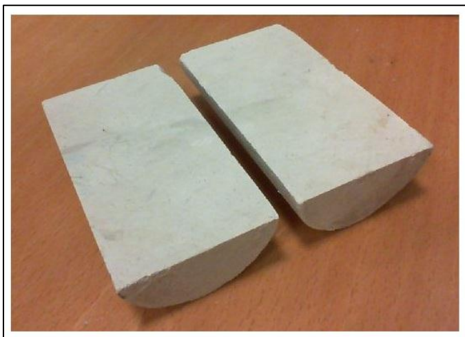
Figur 8.3: Bilde av kjerneprøve PC3 etter at den hadde blitt flømmet med flytende CO 2 i en sekundær utvinningsprosess.
