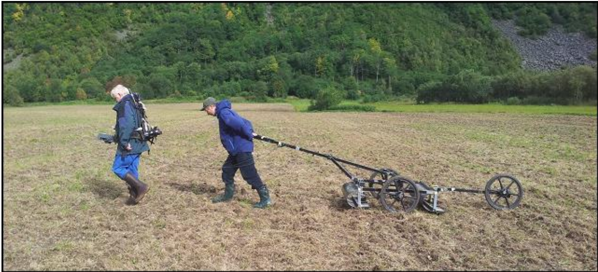
Figur 2.2 Utføring av georadarmålingar, her: Jan Fredrik Tønnesen (NGU) går fremst med GPS, datamaskin og batteri på ryggsekken, medan Lars Olsen (NGU) trekk vogna med sendaren og mottakaren, antennene og odometerhjulet.
