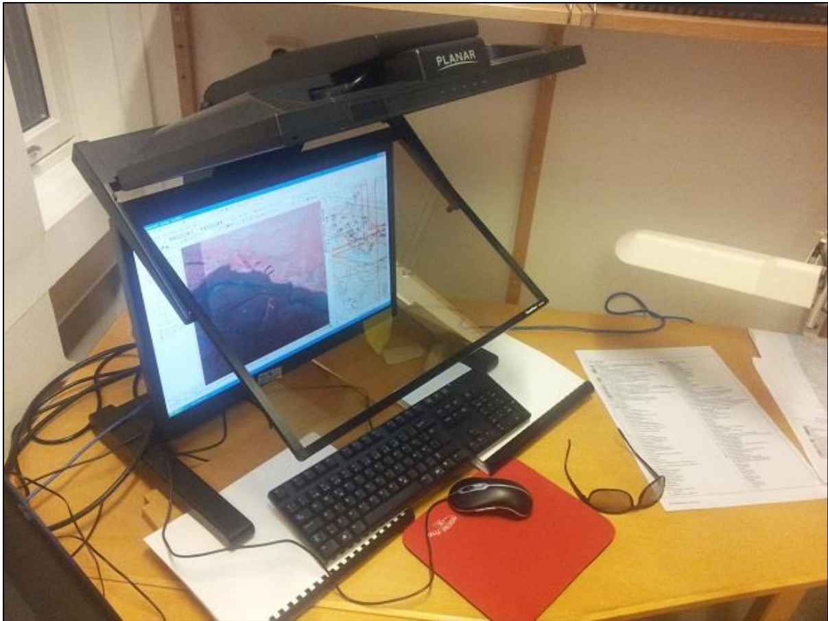
Figur 2.1 Utstyret som vart brukt i den digitale kartlegginga ved NGU: datamaskin med ESRI Stereo Analyst, dataverktøyet ESRI ArcGIS versjon 9.3.1, digitale flyfoto og 3D-briller.
