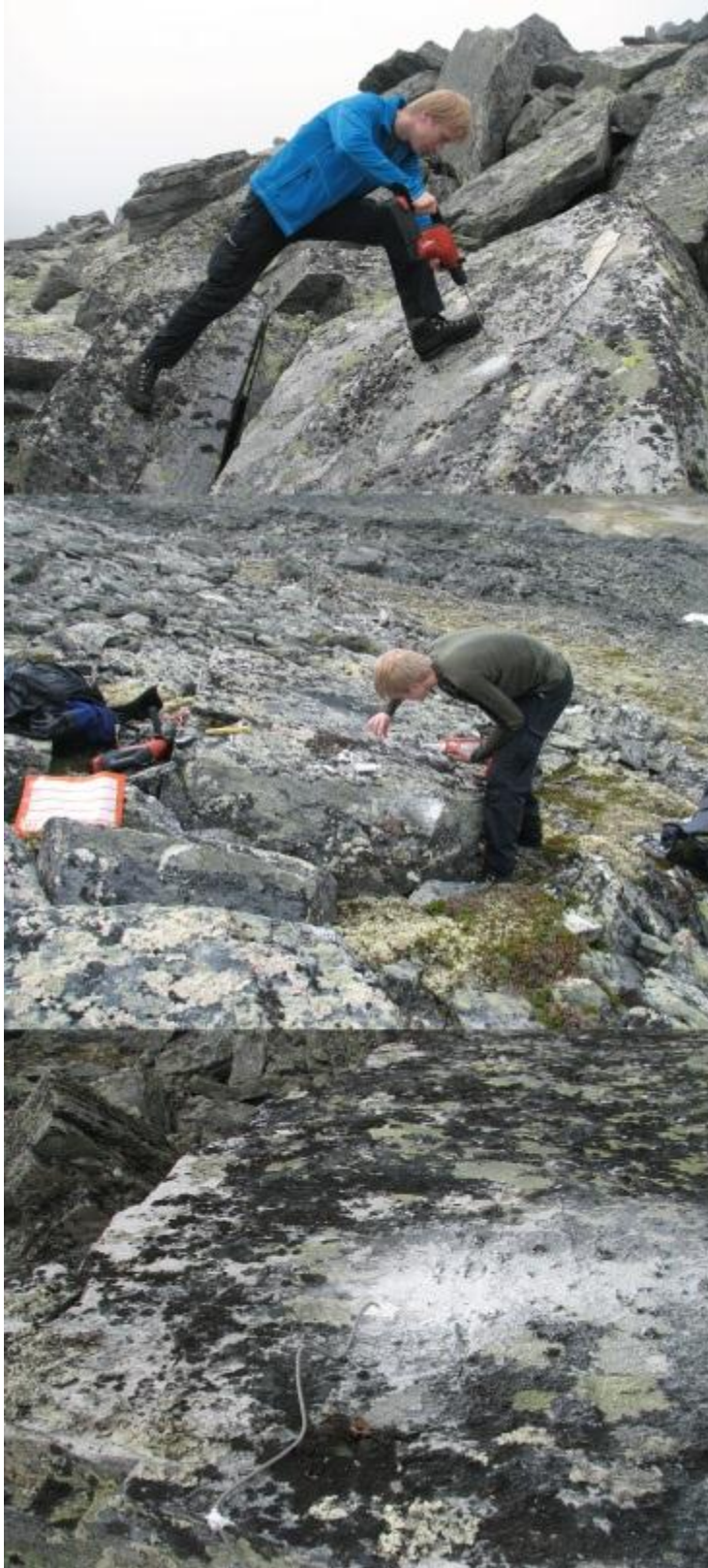
Figur 3-8: Monteringsprosedyre for temperaturloggerne som ble boret inn. Først bores hullet (dybde måles med en linjal på boret), så føres temperatursensoren inn før man til slutt tetter hullet med silikon. Foto: Håvard Juliussen.
