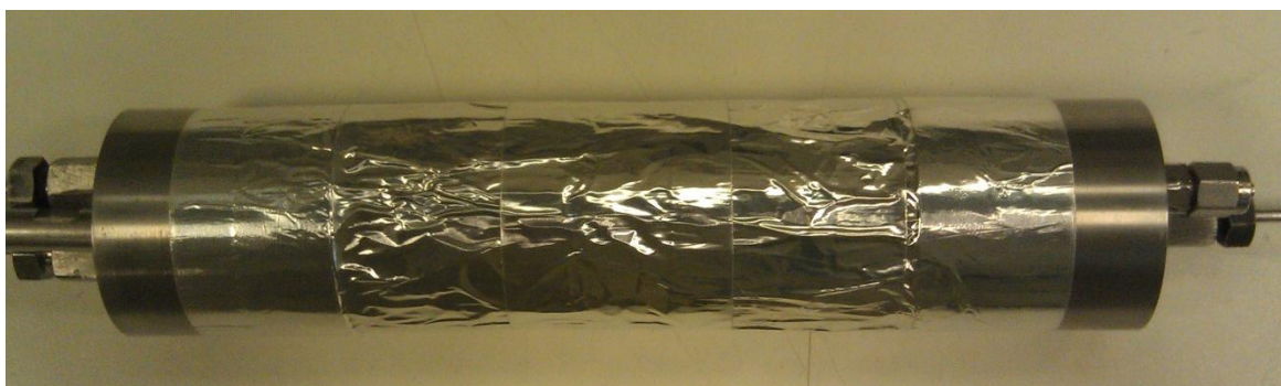
Figur 36: Klargjøring av kjerne for Hassler holder.
