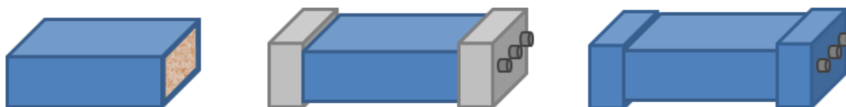
Figur 30: Illustrasjon av stegene for pålegging av epoksy på blokk, før og etter endestykkene ble satt på [54].
