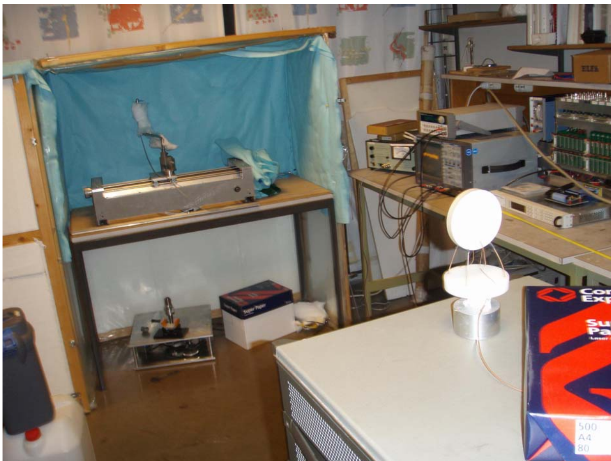
Figur 4.5: Måleoppstilling i luft for akustiske målinger. Avstand mellom element og målemikrofon er 269,5cm. Mikrofonen står på måleriggen i måleburet med justeringsmuligheter i 3 akseretninger, mens elementet står i en holder hvor det kan dreies rundt egen akse uten å påvirke avstand til målemikrofon.
