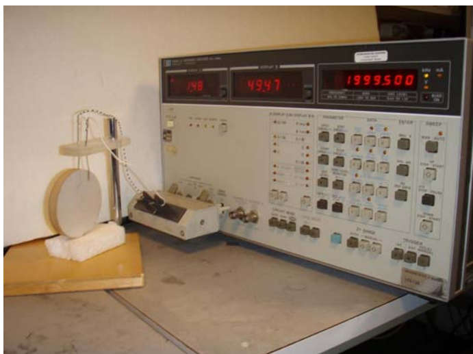
Figur 4.3: Måleoppstilling for elektrisk måling av elementene med impedansanalysator
