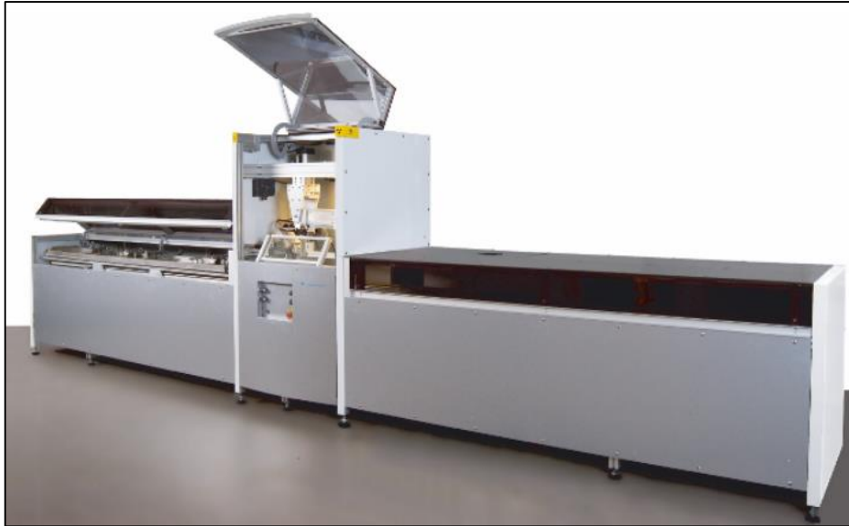
Figur 3.6: ITRAX XRF- kjernelogger, lik den ved Universitetet i Bergen. Kjerneloggeren er vist forfra og har åpen hetter. Delte kjerner blir lagt til venstre og ført gjennom kjerneskanter-systemet som befinner seg i midten av skanneren (Figur 3.7) (Croudace et al. 2006).
