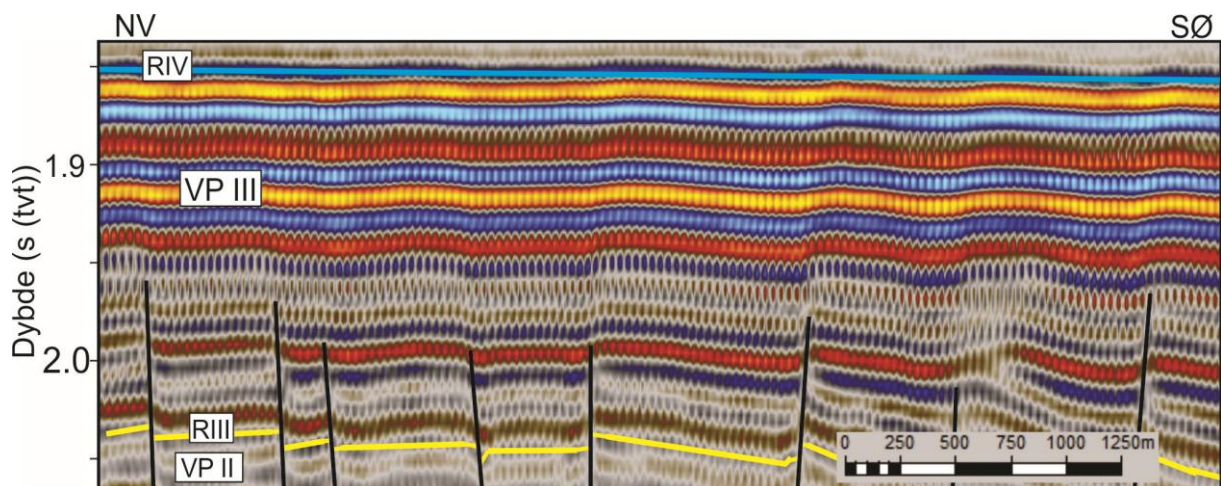
Figur 4.33. Enhet VP III kjennetegnes av parallelle reflektorer med middels til høy amplitude, og deler av enheten påvirkes av forkastninger. Figurens lokalitet er markert på Figur 4.30.
