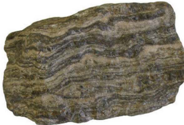
Figur 6.4: Eksempel på foalisjonen til bergarten Gneist. I følge [4] vil varmeledningsevnen være størst parallellt med foalisjonen. Dette viser at varmeledningsevnen er anisotropisk. Figuren hentet fra [49].
