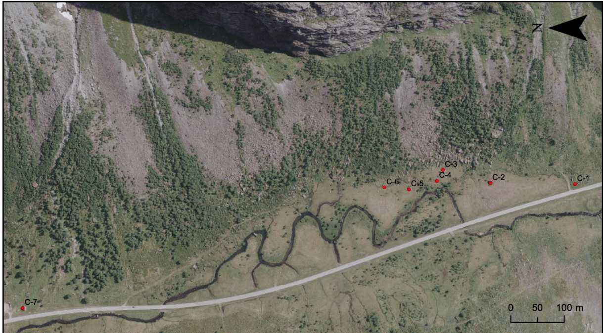
Fig. 5.35: De røde punktene representerer hvor det er tatt schmidthammermålinger i lokalitetstype C.
