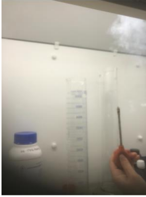
Figur 11 Luftstrøms retning test ved Dräger Air Flow Tester KIT vises ved røykretning mot avsug i avtrekkskap.
