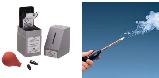
Figur 4 Vurdering av luftstrømmen under avtrekkskap med Dräger Air Flow Tester KIT. Hvitt røyk viser retning til luftstrøm
