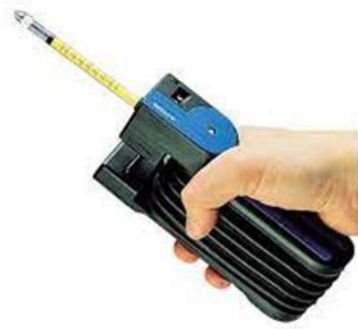
Figur 3 Måling av konsentrasjon av en gass i luft med et fargeindikatorrør koblet til en håndpumpe
