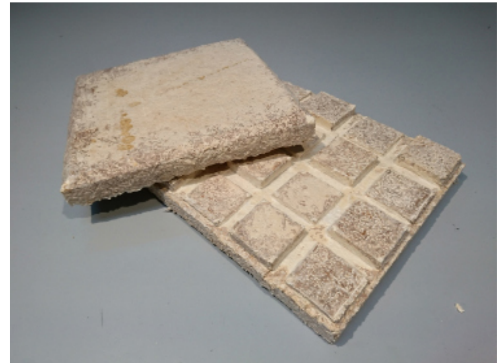
Fig.39 Materialprøver fra Sopp og Hamp-biomasse. Laget av Hesam Booryaei, pressformen er laget av meg. Dette er eksempler på materialer som kan brukes til sitteunderlag og lyddemping, 2020.
