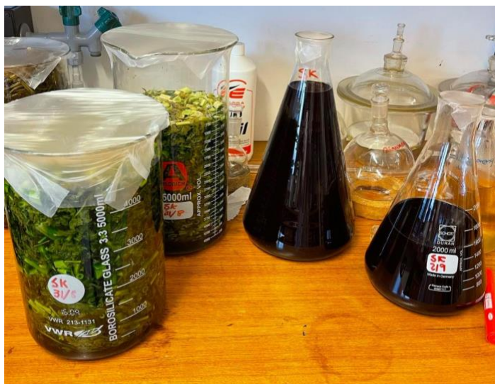
Figur 17: Filtrert metanolekstrakt etter første ekstraksjonsrunde, samt ny ekstraksjonsrunde av plantematerialet med ny metanol (HPLC-kvalitet).
