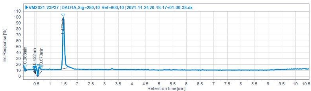
Figur 281: UHPLC-kromatogram av E -sinapinsyre 4- O - \beta -glukopyranosid ( 7 ) i fraksjon VM2S21-23P37 detektert ved 280 \pm 10 nm.
