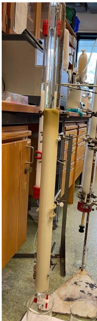
Figur 14: Bilde er tatt av forfatteren selv den 17. september 2021 og viser amberlite XAD-7 kolonnekromatografi.
