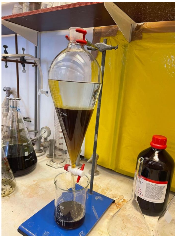
Figur 12: Skilletrakt med faseskille mellom oppkonsentrert planteekstraktet og petroleumeter. Petroleumeterfasen er øverst. Bilde er tatt av forfatteren selv og viser prinsippet bak 2-fase ekstraksjon.
