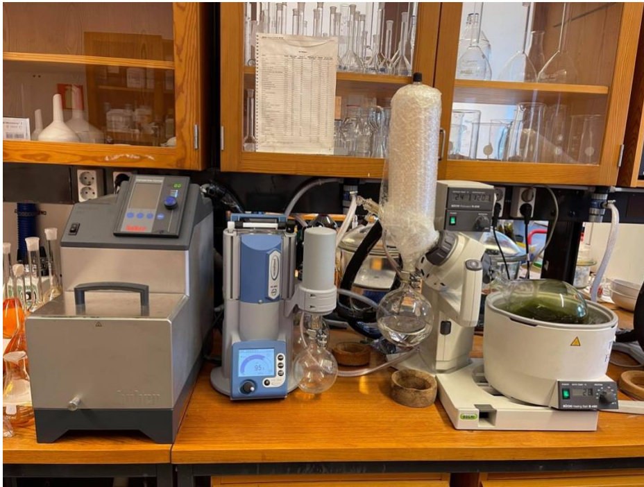
Figur 11: Rotavaporsystemet som ble brukt til å kondensere ekstrakt fra spansk kjørvel. Bilde inneholder kjøleanlegg, vakuumpumpe og rotavapor med vannbad, oppsamlingskolbe og avdampingskolbe med ekstrakt.
