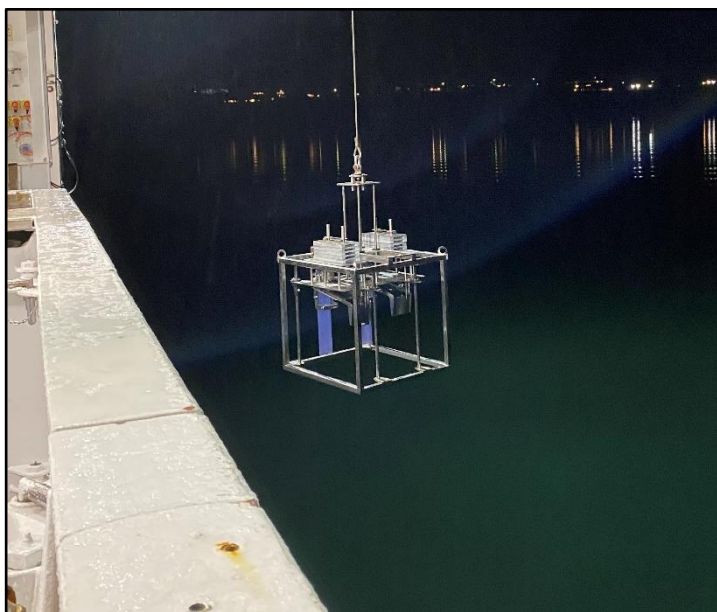
Fig. 3.2.3. Multikjernetaker – her kun utrustet med 2 rør (Foto: Mangersnes, 2021).
