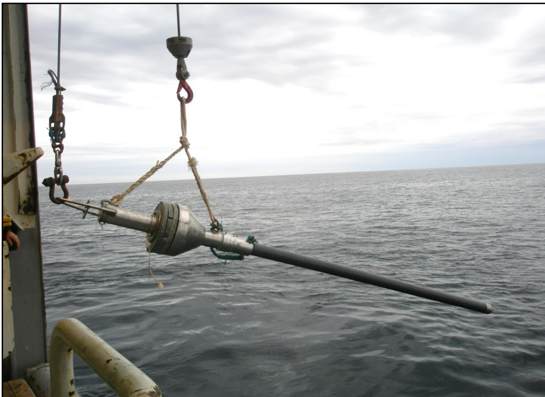
Fig. 3.2.2: Fallkjernetaker klar til å senkes ned i havet (Foto: H. Haflidason)
