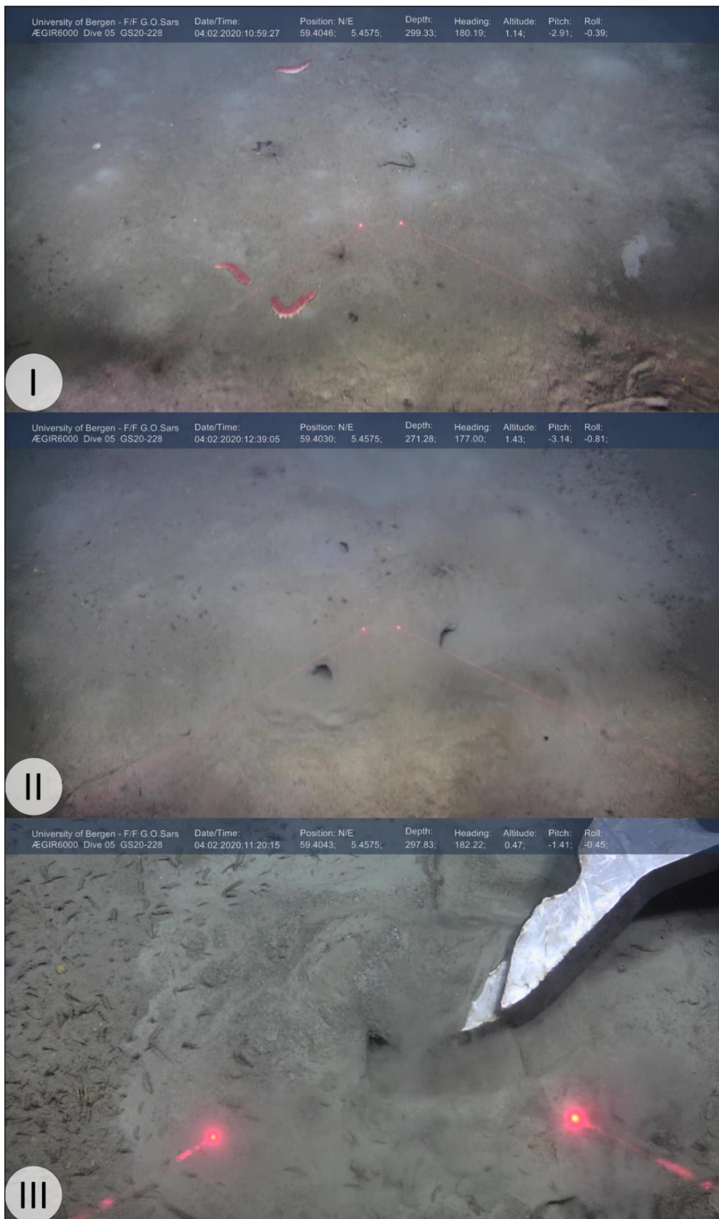
Fig. 4.4g: Sammensatt oversiktsbilde over karakteristiske trekk og spennende funn i ROV-transektet: I) typisk havbunn i fjorden med bioturbasjon, infaunale dyr og sjøpølser, II) bioturbasjon med synlige, åpne grave ganger, III) nærbilde av havbunnsedimentene; venstre del viser det marine gytjelaget mens venstre del hvordan de litiske sedimentene under ser ut.
