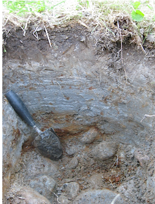
Figur 2.11: Snitt tatt på breelvsletten og viser lagdeling av silt, sand og grus. Murskje som målestokk. Bilde tatt mot nord- øst.
