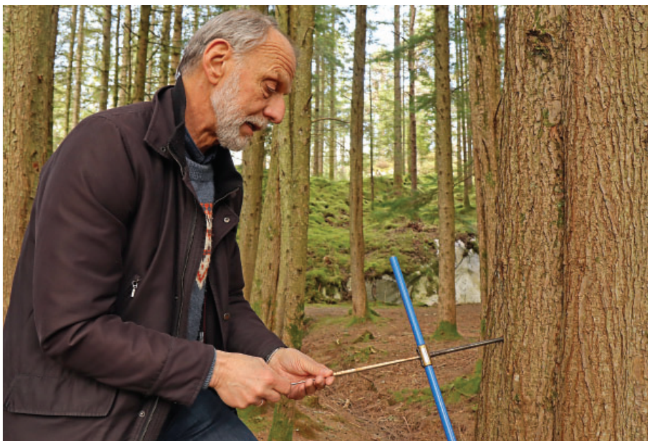
Treproven: Treproven trekkes forsiktig ut av boret. Nå kan årringene telles (foto: forf.).
