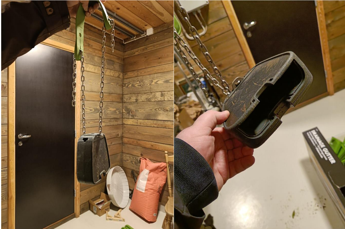
Bilde 4: Venstre: Nofence klave for kyr med nakkereim montert på enden av kjettingene. Høyre: Nofence-klave for kyr der hullet for batteriet er synlig. Kilde: Egne bilder.
