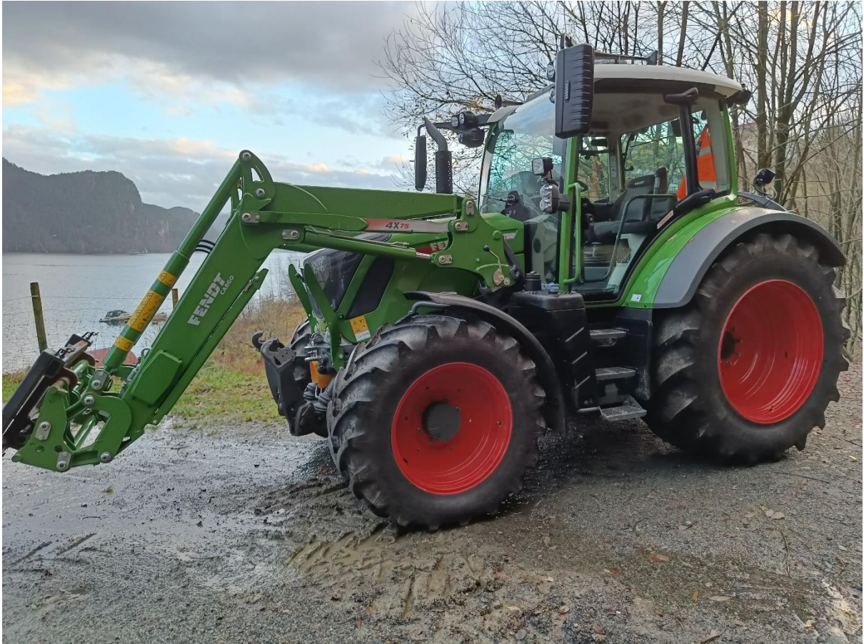
Bilde 11: Autostyrt traktor ser lik ut som en vanlig traktor for det utrente øye. Men bemerk deg sensor-pakkene oppe på kabinen, slik er det roboten ser deg og andre ting som kommer i veien. Kilde: Eget bilde.
