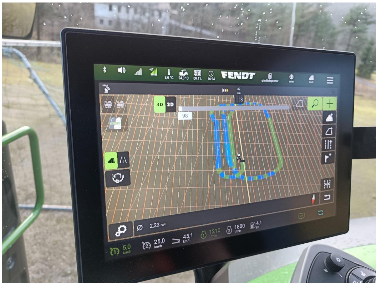
Bilde 6: Eksempel på linjeoppsett for en autostyrt traktor, med markeringer for hvor vi allerede hadde «dekket jordet» i blått, og hvor vi hadde kjørt i grønt. Kilde: Eget Bilde.
