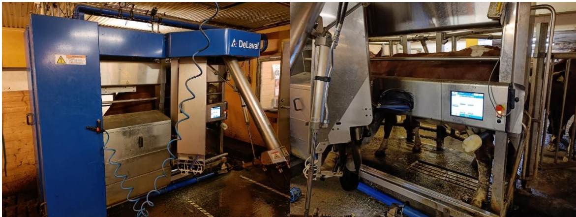
Bilde 2: Venstre: Robotens melkeenhet, til høyre kan robotens melkearm sees. Den har ett kamera og kan plukke opp og feste spenekopper til dyrets jur. Høyre: Melkeenheten har en touch-skjerm som lar bonden manuelt styre enheten, om nødvendig. Kilde: Eget Bilde.
