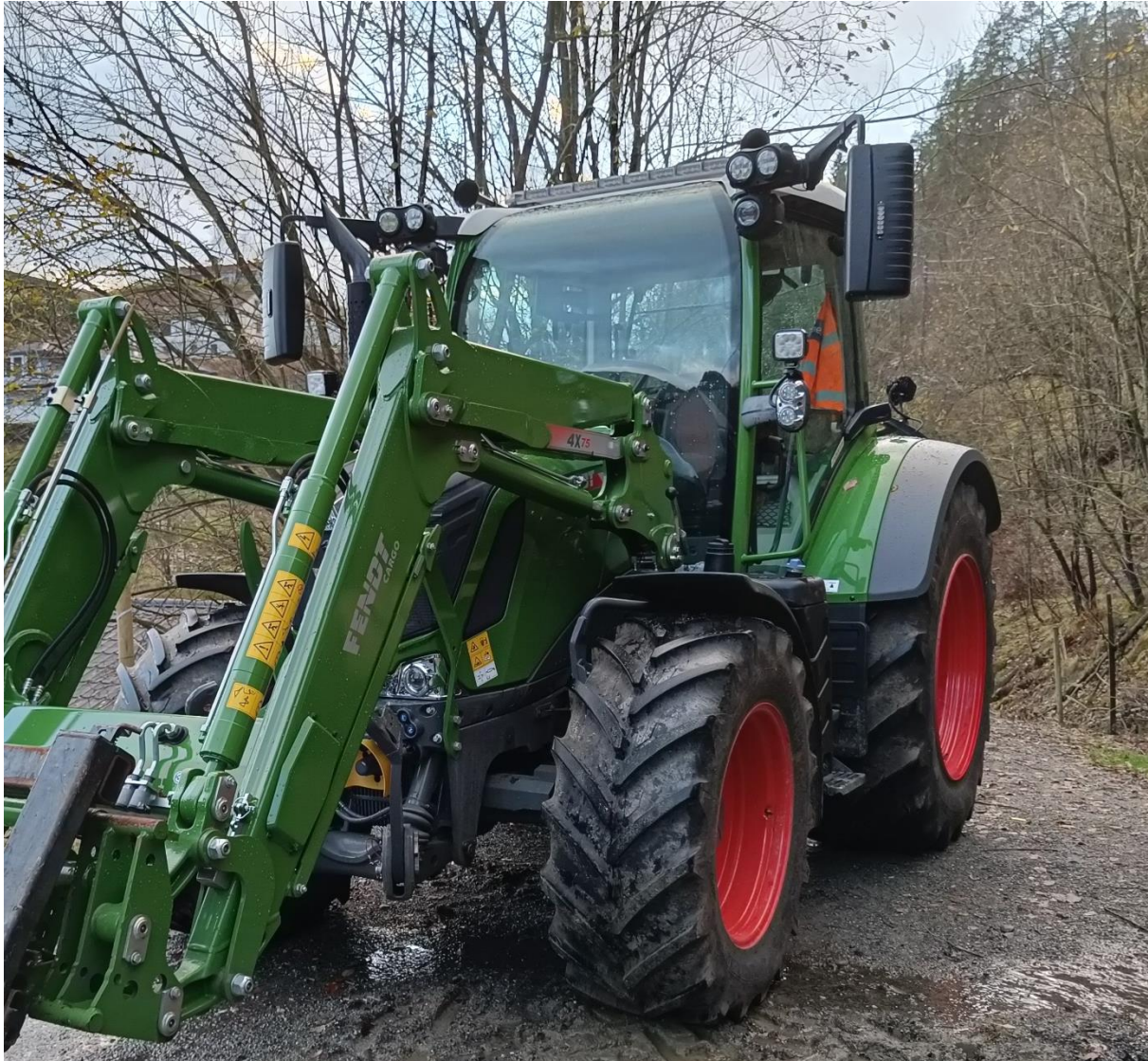
Bilde 5: Øverst i hjørnene på traktorens kabin ser du de to pakkene med 3 øye-sensorer traktoren bruker til å navigere og unngå ting som kommer i veien. Kilde: Eget Bilde.
