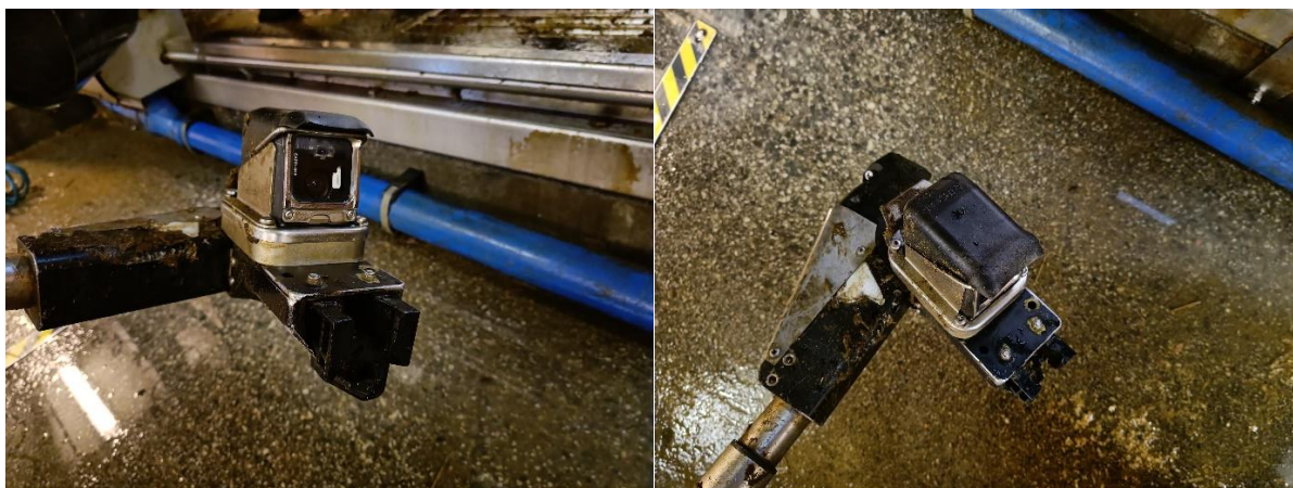
Bilde 9: Robotarmen på en DeLaval melkerobot sett fra to vinkler, med kamera foran og en klype under til å ta tak i melkekopper. Dette lar maskinen unngå og melke jur som er betente, og lar også bonden manuelt sette på koppene hvis det skulle være noe galt med armen. Kilde: Meg Selv.
