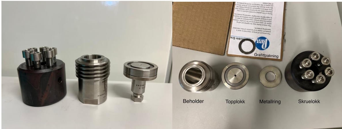
Figur 3-6: Åpen reaktor benyttet i trinn 3, sett fra siden og ovenfra. Dette var en helt ny, ubrukt reaktor.
