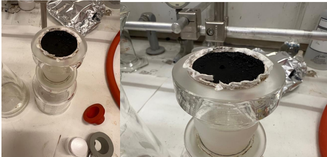
Figur 3-9: Viser utfordringene ved filtrering av koks. Filterpapiret sitter fast i glassfilterdigelen.
