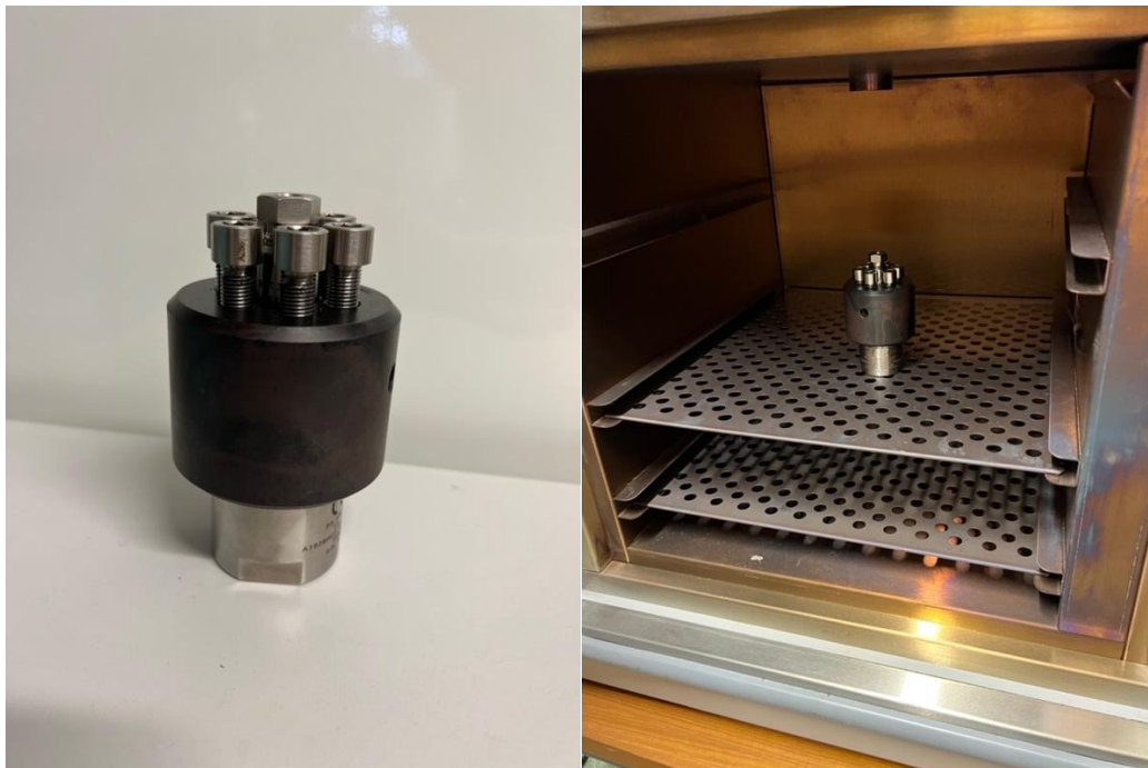
Figur 3-7: Lukket reaktor. Venstre: Skruene er ikke skrudd helt ned. Høyre: reaktoren i varmeovn.
