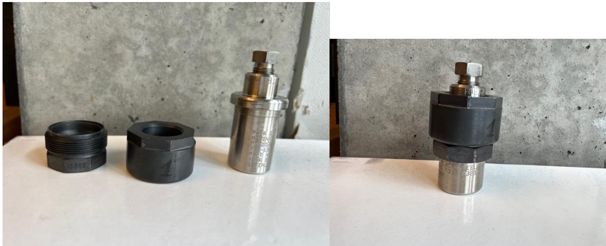
Figur 3-4: Reaktoren benyttet i trinn 2 -dehydrering. Til venstre: åpen reaktor. Til høyre: lukket reaktor.
