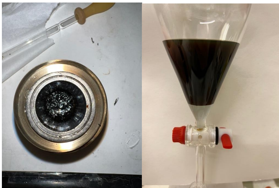
Figur 3-8: Bilder fra opparbeiding. Venstre: Koksen i reaktoren etter åpning. Høyre: Vannfase og oljefase i skilletrakt før separasjon.
