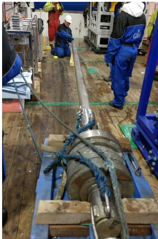
Fig. 3.1: Bilde av fallkjernetakeren. Tre meter med plastrør er montert på loddet som ligger nærmest. I enden på røret er det montert en sediment-fanger. Foto: Simon Johan Rød.
