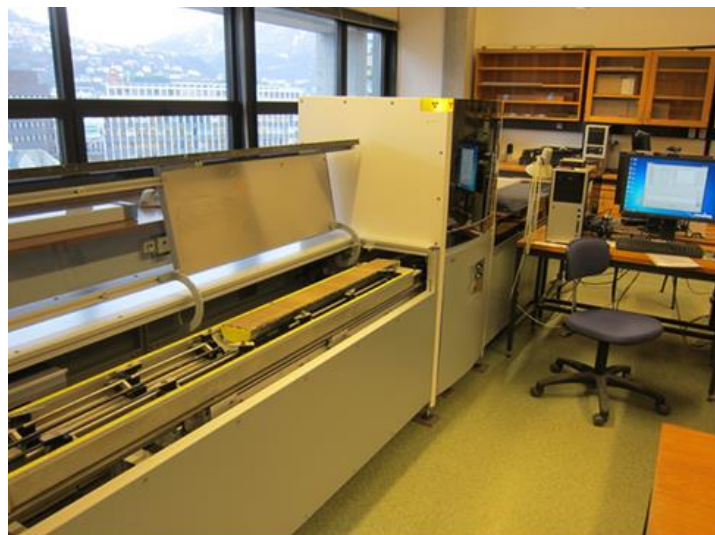
Fig. 3.2: Itrax XRF skanneren ved sedimentologisk lab på UiB, Earthlab. XRF-skanneren kontrolleres fra datamaskinen til høyre i bildet. Foto: Haflidi Haflidason.
