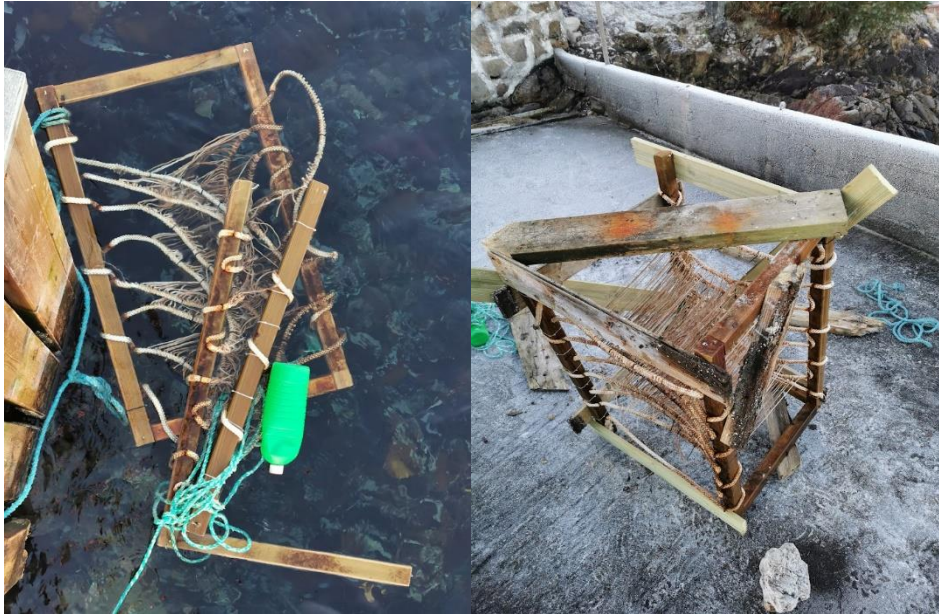
Figur 22: Testriggen i knust tilstand (til venstre), og nybygd tilstand (til høyre).
