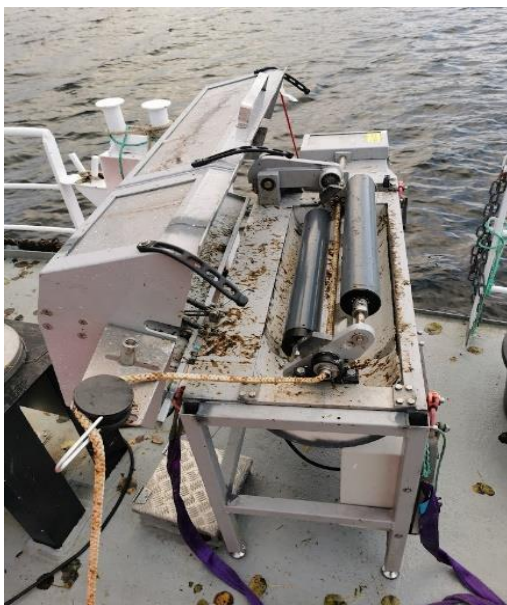
Figur 7: Trommelmaskin som skal snurre tynn-tråden (tråden med sporofyttar) rundt berelina.
