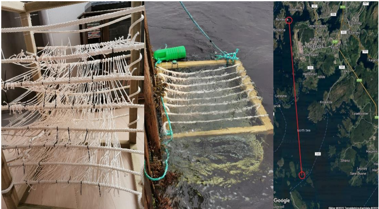
Figur 11: Oppsett for brotstyrke forsøk. Til venstre: Brotstyrke test-rigg. I midten: Rigger i sjø. Til høgre: Lokalitet for test (Bjørøyna) mot lokasjon i sjø (Austevoll).
