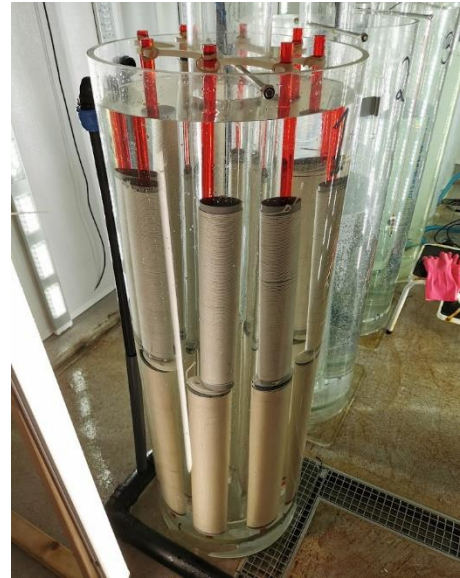
Figur 6: Kar med ferdig utsette spolar for det storskala forsøk. Spolane med mitt forsøk er dei øvste av dei to høgdene med spolar. Det er lys frå alle sider, og det vert og sett ned eit lysrøyr i midten av tanken.
