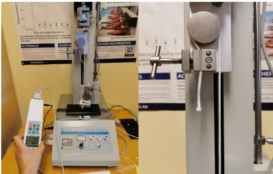
Figur 12: Strekkmaskin som les av brotstyrke og topp-verdien i newton når tråden slitnar, maskina er lånt av HI.
