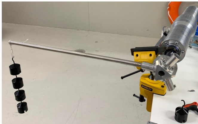
Figur 28: Oppsett for kalibrering av QT-sensor.
