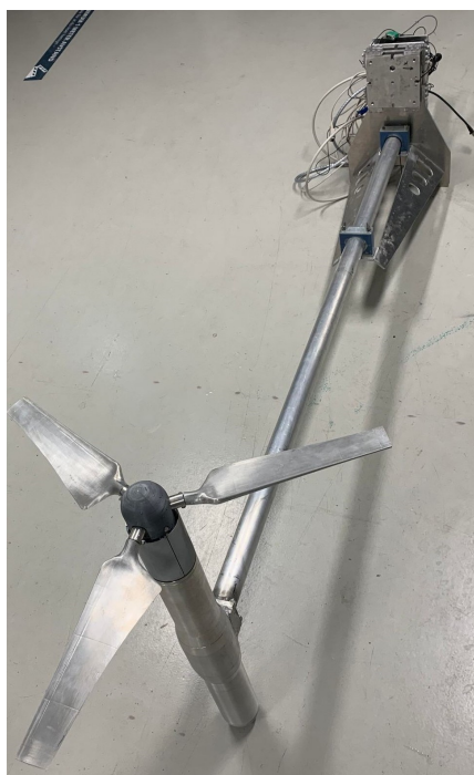
Figur 1: Modellturbin benyttet til eksperimentelle undersøkelser i MarinLab.
