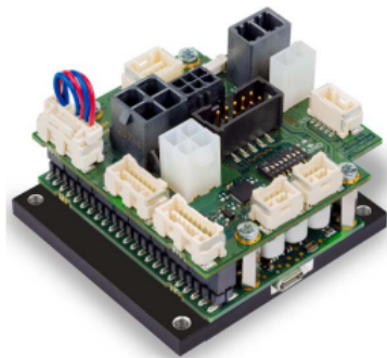
Figur 14: Kontrolleren som kontrollerer Maxon EC-i-52 motoren.
