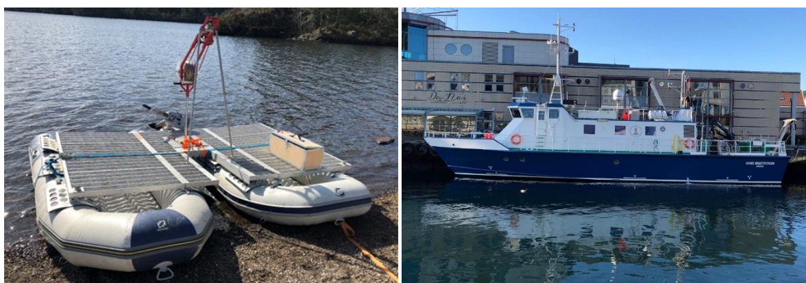
Fig 3.2. Venstre: flåte med vinsj benyttet under prøveinnsamling i Storavatnet. Høyre: F/F Hans Brattstrøm.
