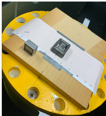
Figur 33: Illustrasjon av utførelsen av krengeprøven med vektlodd, millimeterpapir og vinkelmåler.
