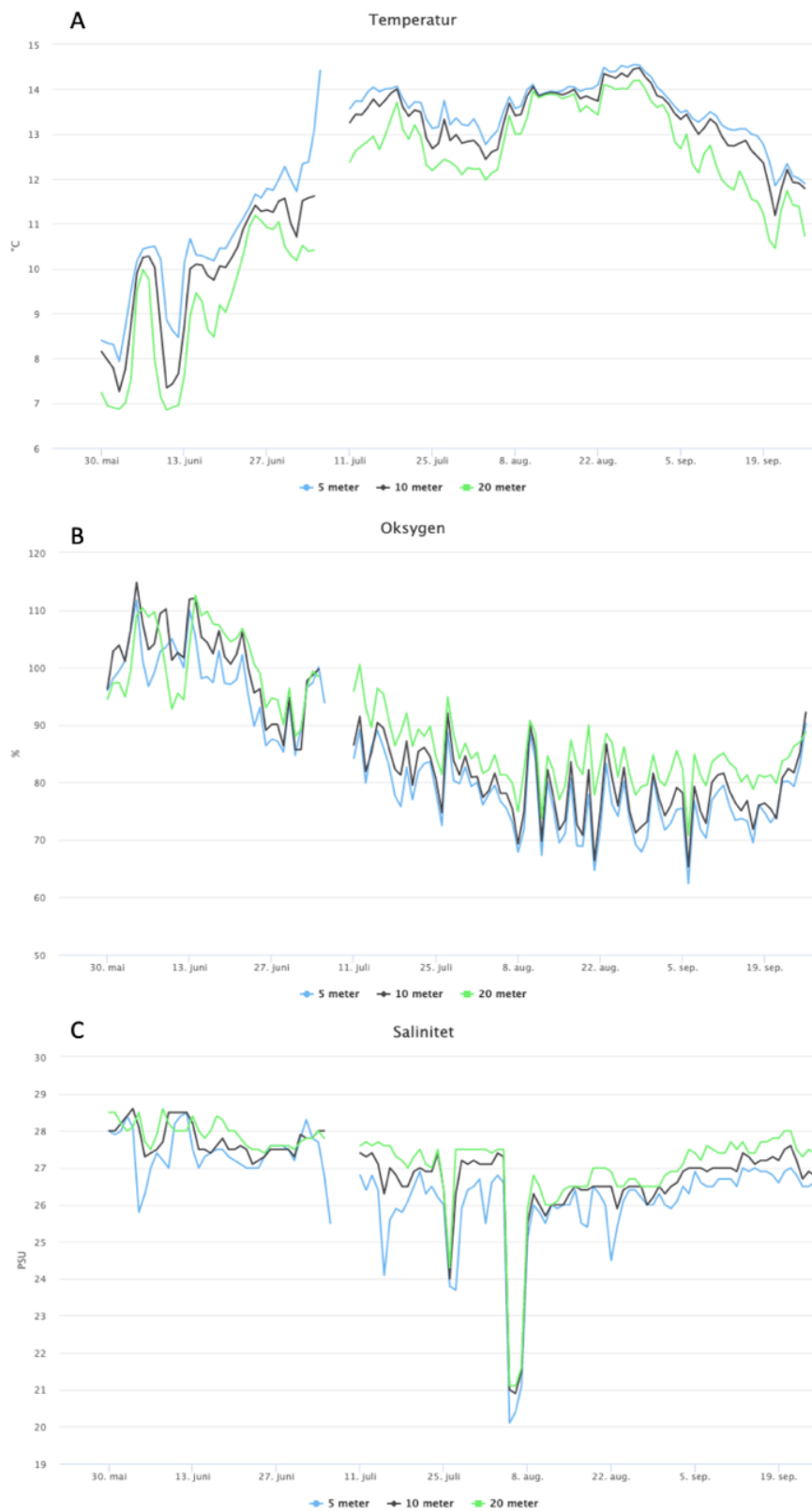
Figur 3.2 A-C: Miljømålinger på Heggvika (F1). A: Temperatur (°C), B: Oksygen (%), C: Saltholdighet (PSU) på ulike dybder (5,10 og 20m) fra REF4 mai til september. Kilde: Sea Smart drone.
